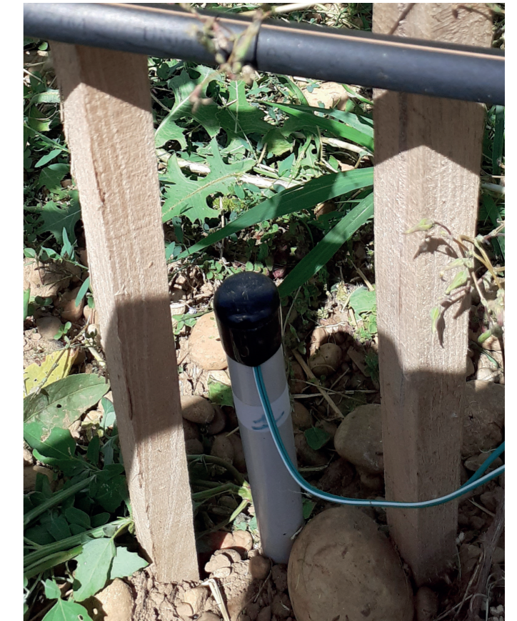
Tensiomètre mesurant l'humidité du sol et permettant le pilotage de l'irrigation : c'est une sonde insérée directement dans le sol pour mesurer la tension de l'eau du sol - l'effort requis par le système racinaire pour extraire l'eau stockée dans le sol.
