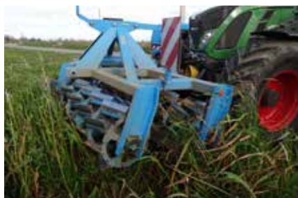
Roll Krop. Les rouleaux hacheurs type rolo faca ou roll Krop sont plus efficaces mais nécessitent un investissement spécifique.
